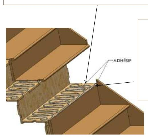
Note: S'assurer d'appliquer l'adhésif à l'intersection des sections de revêtement. (Précisément à l'endroit où la marche du bas de la seconde section de revêtement repose sur la contremarche du haut de la section de revêtement précédente.
